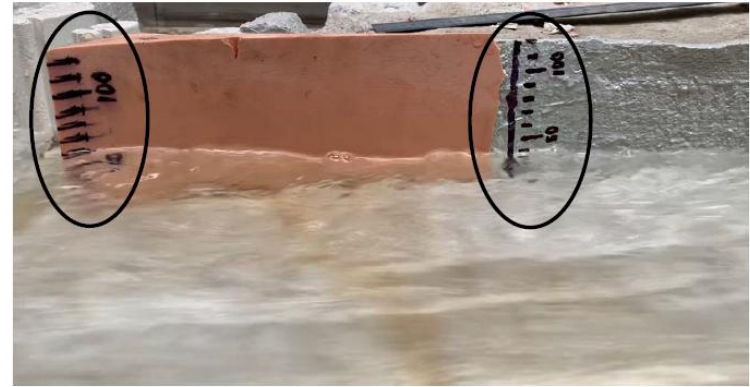
Figur 10. Lite öppen B-lucka med spillflöde ca Q_B=400 \text{ m}^3/\text{s} (lucka A helt stängd). Vattendjup vid början av kilen ca 2.0 m och vid slutet av kilen ca 3.5 m som mest.
