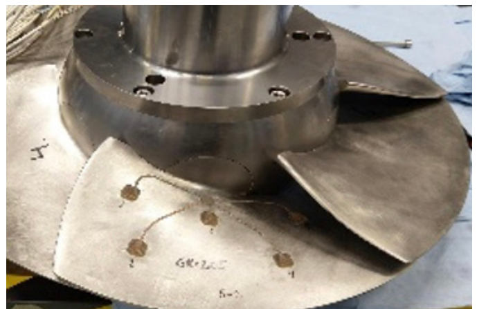
Figure 3: Instrumentation of a turbine model for load measurements in Älvkarleby (Vattenfall)
